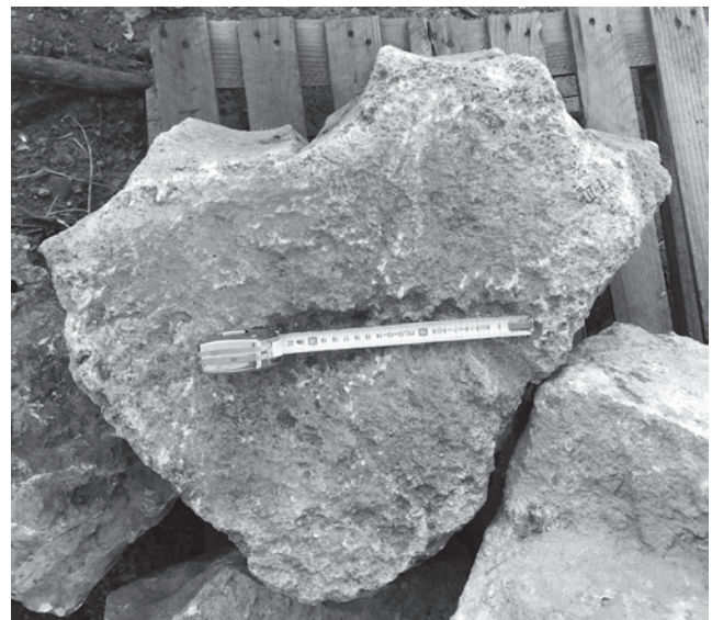
Fig. 21.11: Rib voussoir (sandstone), concave template. Dimensions: 57 \times 50 \times 45 .
